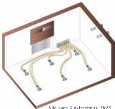
Silo avec 6 extracteurs RAPS et commutation automatique
