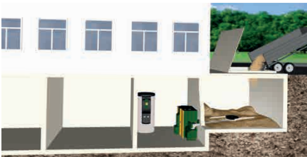
KWB Multifire avec dessileur et vis de transport ; remplissage direct du local de stockage
