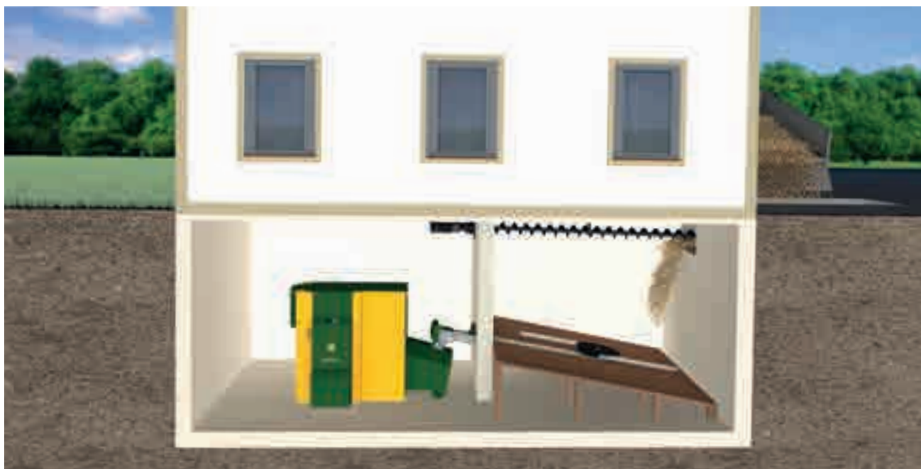
KWB Multifire avec dessileur et vis de transport ; remplissage direct du local de stockage par vis de remplissage
