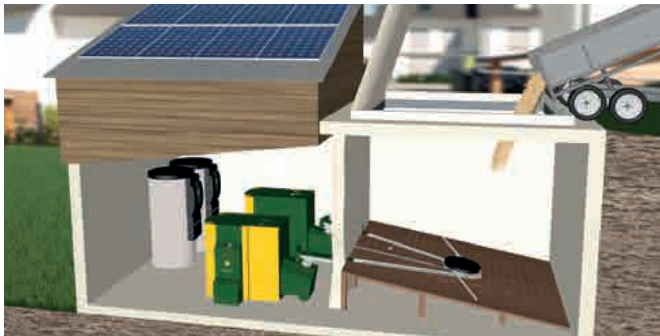
Installation double KWB Multifire avec dessileur et 2 vis de transport ; remplissage direct du local de stockage
