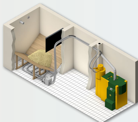
Sondes de prélèvement KWB avec transport par aspiration
