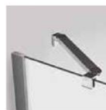
ÉQUERRE D'ANGLE long. 570 mm Fixation sur le verre de la paroi fixe / Permet de stabiliser une paroi fixe seule au mur. UNIQUEMENT pour paroi fixe < 600 mm. Pour le vitrage épaisseur 5, 6, 8 mm.
