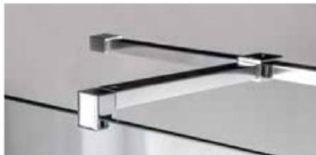
BARRE DE STABILISATION ADDITIONNELLE DOUCHE OUVERTE / Fixation sur le verre de la paroi et sur la barre murale principale / Permet de stabiliser une paroi fixe en retour. Obligatoire pour une paroi JAZZ+ \geq 800 mm.
