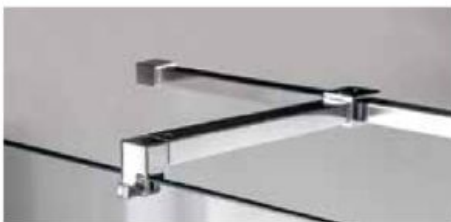
Barre de stabilisation additionnelle Douche Ouverte avec patère Pour les vitrages : 4, 6, 8 mm Fixation sur le verre de la paroi et sur la barre murale principale/Permet de stabiliser une paroi fixe en retour. Obligatoire à partir de 800 mm
