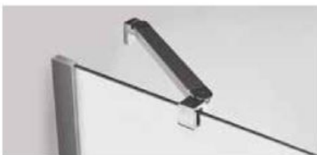
Équerre d'angle long. 570 mm Fixation sur le verre de la paroi fixe / permet de stabiliser une paroi fixe seule au mur. Uniquement pour paroi fixe < 600 (sauf JAZZ+ inférieur à 800 mm) Pour le vitrage épaisseur 5, 6, 8 mm.
