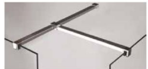
Barre de stabilisation Additionnelle Douche Ouverte Pour les vitrages : 4, 6, 8 mm Fixation sur le verre de la paroi et sur la barre murale principale/ Permet de stabiliser une paroi fixe en retour. Obligatoire à partir de 800 mm retour. Barres recoupables.
