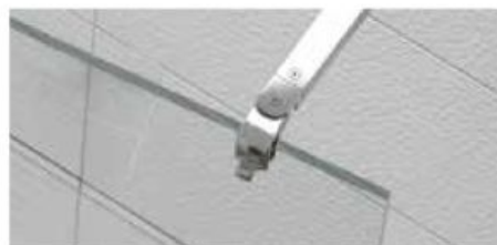
Barre de stabilisation orientable long. 1173 mm Fixation sur le verre de la paroi fixe / permet de stabiliser une paroi fixe seule au mur. Pour le vitrage épaisseur 5, 6, 8 mm.
