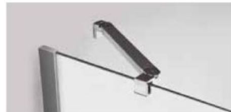
ÉQUERRE D'ANGLE long. 570 mm / Fixation sur le verre de la paroi fixe / Permet de stabiliser une paroi fixe seule au mur. UNIQUEMENT pour paroi fixe < 600 mm.
